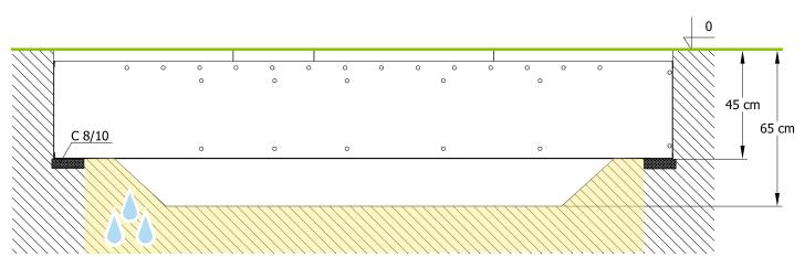
Drained undersoil / Podłoże wodopzepuszczlane / Дренажная подсыпь
